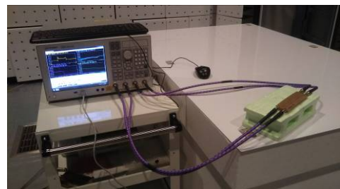
▲図4 E5071C を使用した試作高速伝送路の信号伝送特性評価の様子
