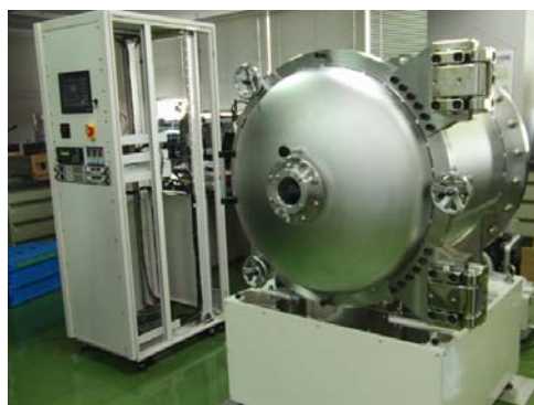
▲ 新型プラズマ照射装置の全体
