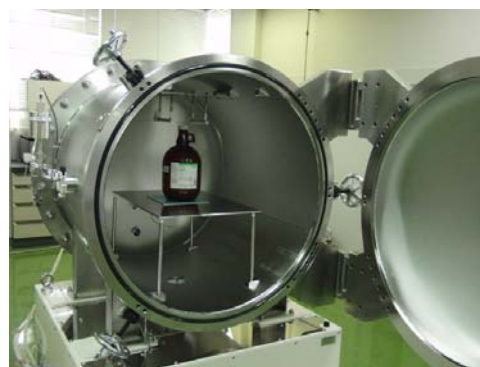
▲ 新型プラズマ照射装置のチャンバー内部
