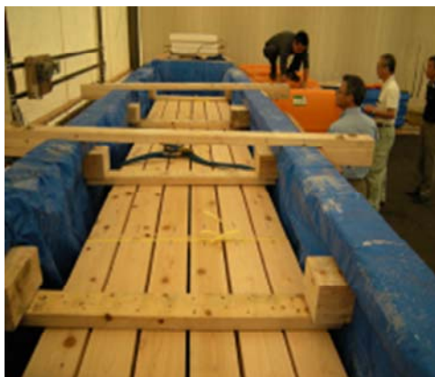
現場組立式浸漬槽による処理の様子
