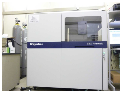
図2 蛍光X線分析装置外観
