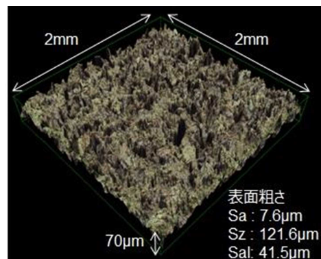
図 2 金属板の三次元形状と表面粗さの測定例
