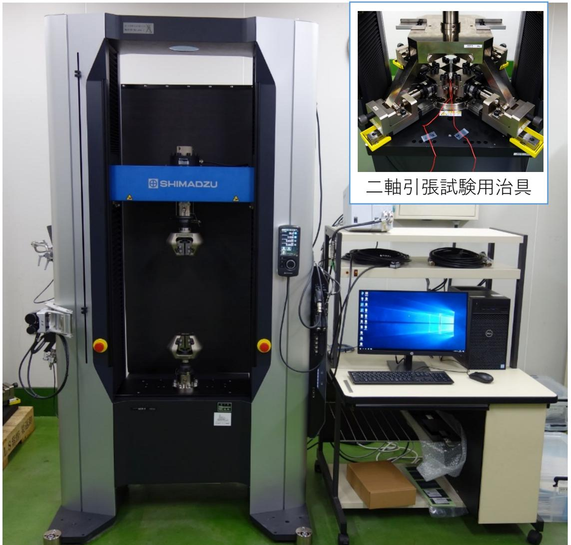
二軸引張試験用治具
