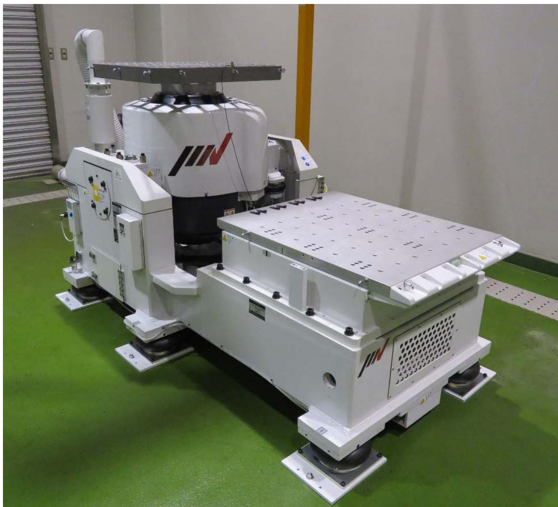
振動試験機は、機械金属製品等に周波数や振幅の異なる様々な振動を強制的に与え、それによって発生する製品の損傷や劣化、動作状況等を検証するための試験機です。
