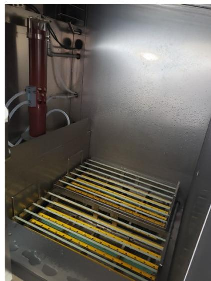
複合サイクル試験機は、金属等の部品や製品を塩水噴霧・湿潤・乾燥・低温・塩水浸漬条件を組み合わせた環境負荷試験を行うことで、様々な条件における耐食性を評価できる装置です。
