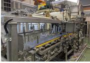
(株)小林製作所<br>ちょい抄きくんSP                 | 様々な機能素材や合成纖維、無機纖維などを木材パルプと混ぜて作る機能紙やCNFを用いたシートを比較的少量の原料で連続的にテスト抄造するための装置。<br>運転速度：0.5～10m/min<br>坪量範囲：20～80g/m <sup>2</sup><br>抄紙幅：350mm            | R1   |
