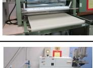
熊谷理機工業(株)<br>No.2575-II               | 手抄きシート等の乾燥処理を行う。<br>ドラム：直径400mm×幅600mm<br>最高温度：180℃<br>搬送速度：0.15～1.0m/min 無段変速                                                              | H29  |
