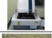
（株）日立ハイテクサイエンス<br>AFM5500M             | 試料表面を微小な探針で走査し、試料の三次元形状や局所的物性を高倍率で観察できる。<br>光てこ方式<br>走査範囲：200μm×200μm<br>ステージ範囲：100mm×100mm<br>観察モード：コンタクトモード、共振モード、位相モード                   | H28  |
