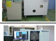
（株）スギノマシン<br>HJP-25005                | ノズルから超高压でパルプなどの原料を噴射させ、原料同士を直接ぶつけることや器壁にぶつけることで微細化させ、CNFを作製する。<br>圧力範囲：100～245MPa<br>理論最大処理量：32L/hr                                         | H29  |
