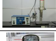
（株）日本精機製作所<br>US-150E                 | TEMPO酸化触媒反応後のパルプに、適度な振動を与えてナノ分散化する。CNFと溶液、粒子等の混合・分散を行う。<br>出力：150W<br>周波数：20kHz                                                             | H28  |
