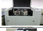
（株）レッチェ（ヴァーダー・サイエンティフィック(株)）<br>PM400MA | パルプからCNFを作製する方法に機械的解繊がある。本装置は、パルプ、水、ボールを入れた容器を回転させ、パルプをボールで粉砕しナノファイバー化する。<br>容器：ジルコニア製500mL×4ヶ                                              | H28  |
