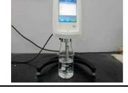
ブルックフィールド<br>DV2TRV                     | CNFの粘度特性を測定することにより分散性やCNFのチキソ性などを評価できる。<br>回転数：0.1～150rpm                                                                                   | H28  |
