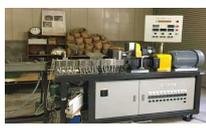
(株)テクノベル<br>KZW20TW-45MG-NH(-1100)-SKG                                 | 加熱・溶融した樹脂とCNFなどのフィラーをせん断を掛けながら混練させる装置。<br>スクリー径：20mm、L/D：45                     | H29  |
