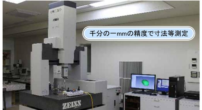
千分の1mmの精度で寸法等測定
