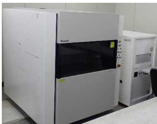
図1 高精度自由曲面測定機
