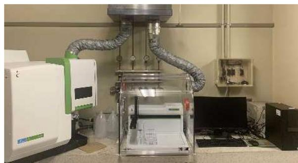
写真 ICP 発光分光分析装置
