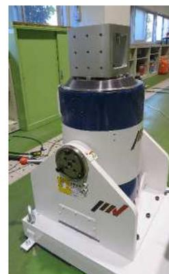
図3 静音小型加振機
