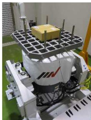
図2 跳ね上がり振動試験
