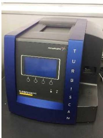
写真 液中分散安定性評価装置
