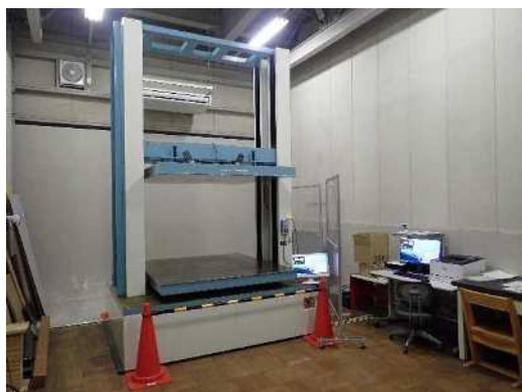
図1 箱型圧縮試験機
