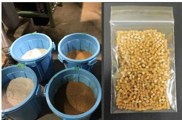
図1 リファイナーで作製した CNF(左)と、PP/CNF20%複合材ペレット(右)
