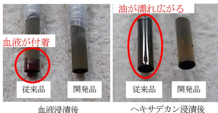
図 1 液体の付着しにくい金属パイプ ( $\phi 1$  mm)
