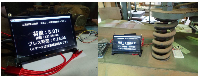
図 1 開発した荷重表示システムと現地適用の様子
