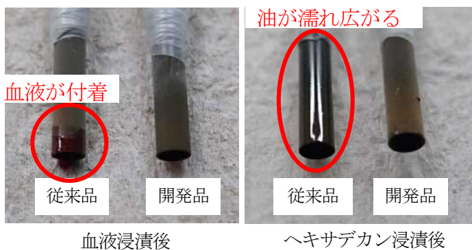
図 1 液体の付着しにくい金属パイプ ( \phi 1 \text{ mm} )
