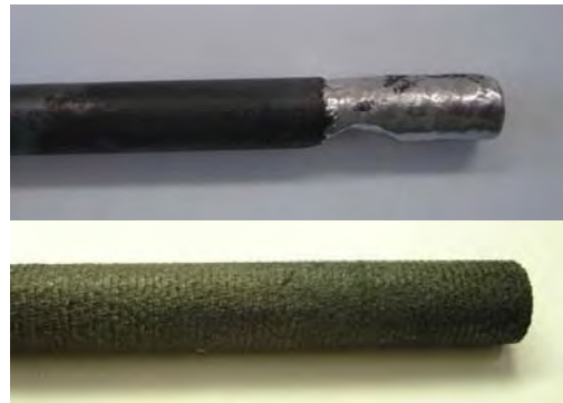
写真 溶損試験後のサンプル (上段：無処理、下段：WC-12Co)
