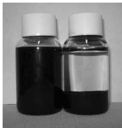
写真2 有機性色素排水のアルカリ・オゾン処理（オゾンガス循環方式）における排水中の有機物の凝集沈殿（左：処理前、右：処理後）
