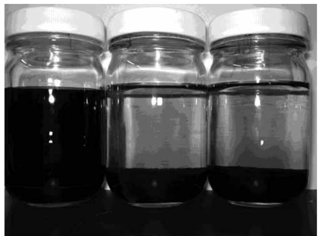
写真1 有機性色素排水のアルカリ・オゾン処理（ワンパス方式）における排水中の有機物の凝集沈殿 （左から \text{Ca}(\text{OH})_2 濃度：20,40,60mM）
