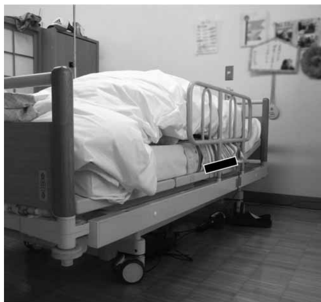
写真2 特別養護老人ホームでの検証実験状況 被験者のマットレス下、胸部付近にセンサシートを設置（図中■部）
