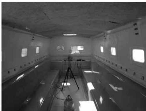
写真3 開発した吸音材料を天井に施工した津波対策用シェルター（残響時間計測の様子）
