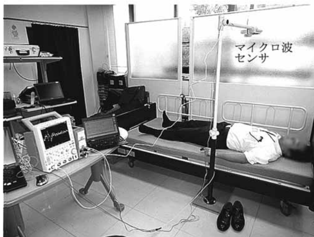
写真2 マイクロ波センサで生体信号を検出している様子（安静にしている人の胸の前では、呼吸や心拍を非接触で測定できる）
