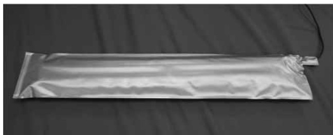
写真1 呼吸・脈拍に起因する身体の動きを計測するためのセンサシート
