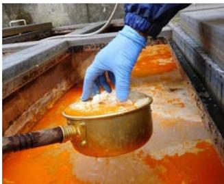
写真1 工場で発生する固形状廃油
