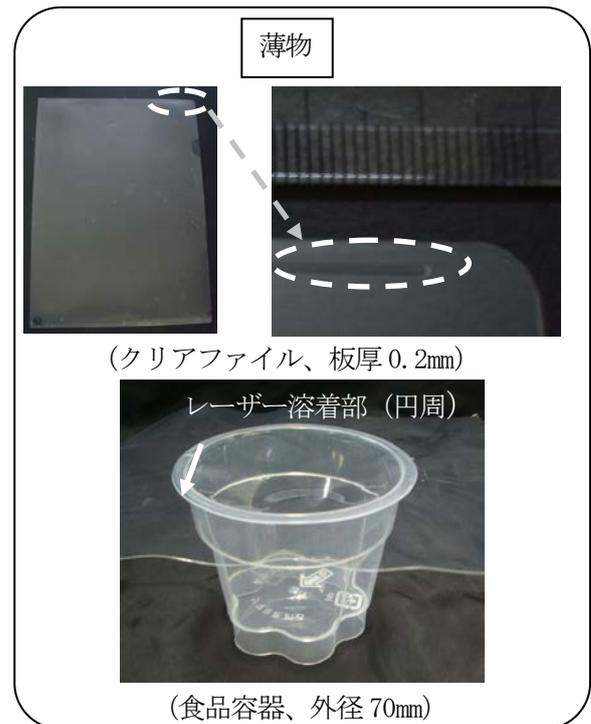
写真 溶着加工例
