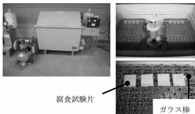
写真1 塩水噴霧試験の概略
