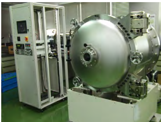
図1 新型プラズマ照射装置実証装置(左:制御系) 図2 チャンバー内部での窒素プラズマ励起状態
