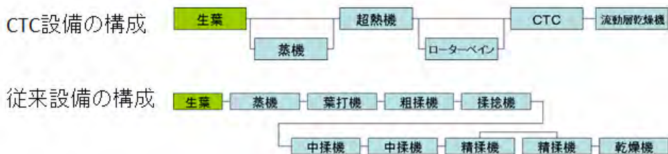
図1 従来法と CTC 法の設備構成の比較
