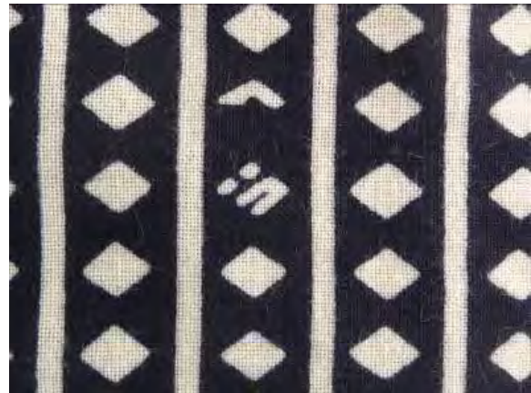
図 開発した防染糊による染色結果
