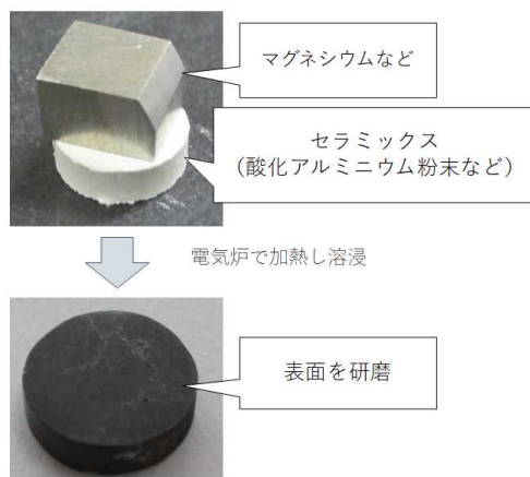
図1 溶浸法による複合材料の作製
