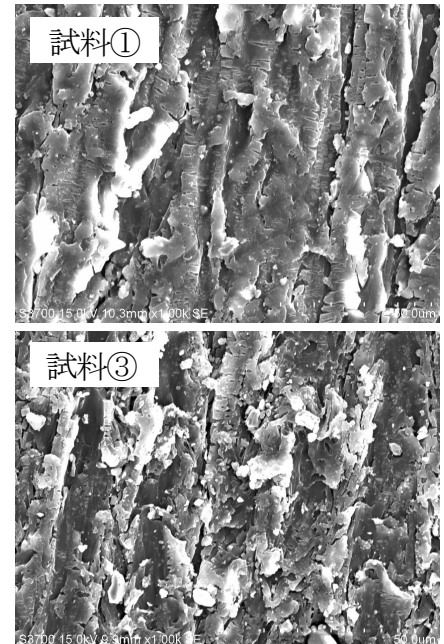
図 2 UV 照射後の電子顕微鏡写真
