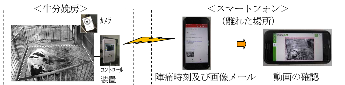
図 牛分娩検知システムの基礎技術モデル
