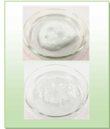
図1 (上)機械的解繊 CNF (下)TEMPO 酸化 CNF
