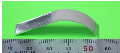
図2 純アルミ（板厚 1mm）の曲げ加工例
