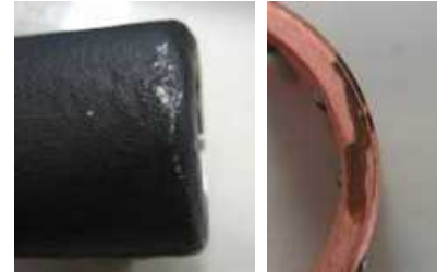
図1 めっき製品の腐食・変色の例
