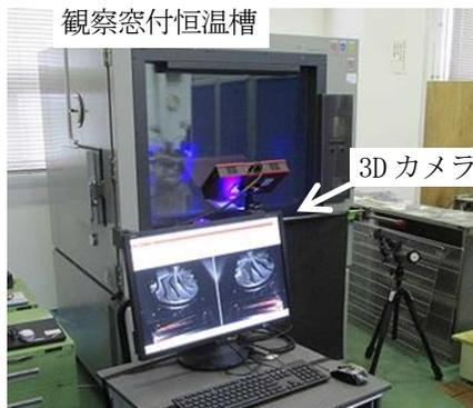
図1 構築した3次元熱変形計測システム
