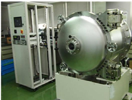
図1 新型プラズマ照射装置実証装置
