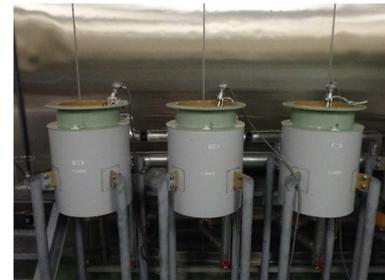
図1 総米6kgの清酒醸造試験の様子
