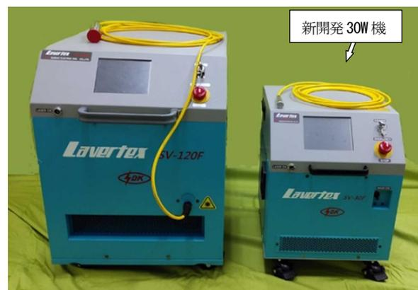
図2 樹脂溶着用レーザー機
