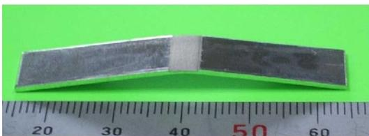
図1 純アルミ (板厚1mm) の曲げ加工例
