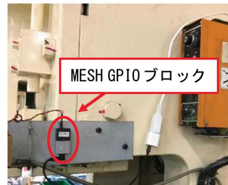
図1 生産設備への取り付け
