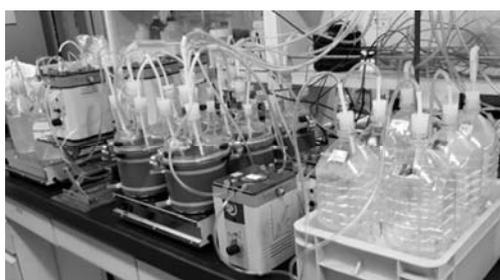
図 メタン発酵連続試験装置の外観
