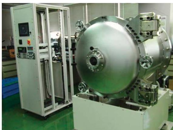
図1 新型プラズマ照射装置実証機
