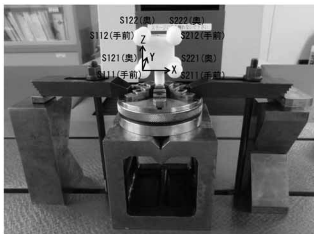
写真8 器物2の固定と座標系の設定
