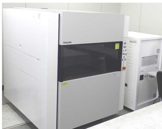
図 高精度自由曲面測定機
