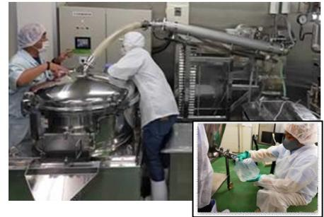
図 真空乾燥型濃縮装置(写真大)とかつお節フレーバー濃縮エキス回収の様子(写真右下)
