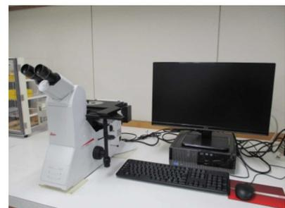
図 3 金属顕微鏡
