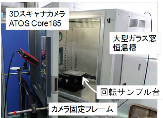
図 1 恒温槽内測定系
