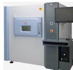
(写真)マイクロフォーカスX線透視装置
