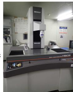
(写真) 接触式三次元測定機
