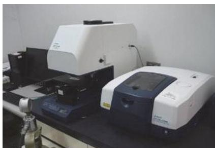
FT-IRは、特定の波長域の赤外線を照射してプラスチック、ゴム等の有機・高分子化合物の定性・同定に加え、無機化合物(金属のサビ等)も分析できます。
