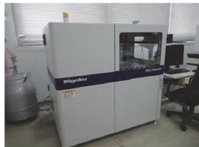
固体や粉末試料に含まれる ${}_{5}B$ から ${}_{96}Cm$ までの元素の高精度分析や軽元素の検出に優れています。試料サイズは最大 $\phi 52 \times t 30mm$ 、分析径は $\phi 0.5mm \sim \phi 35mm$ です。
