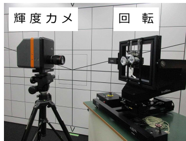
写真 ニアフィールド配光測定装置 (Radiant Vision Systems・PM-NFMS400)
