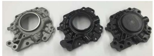
金属成形品と CFRP 成形品
