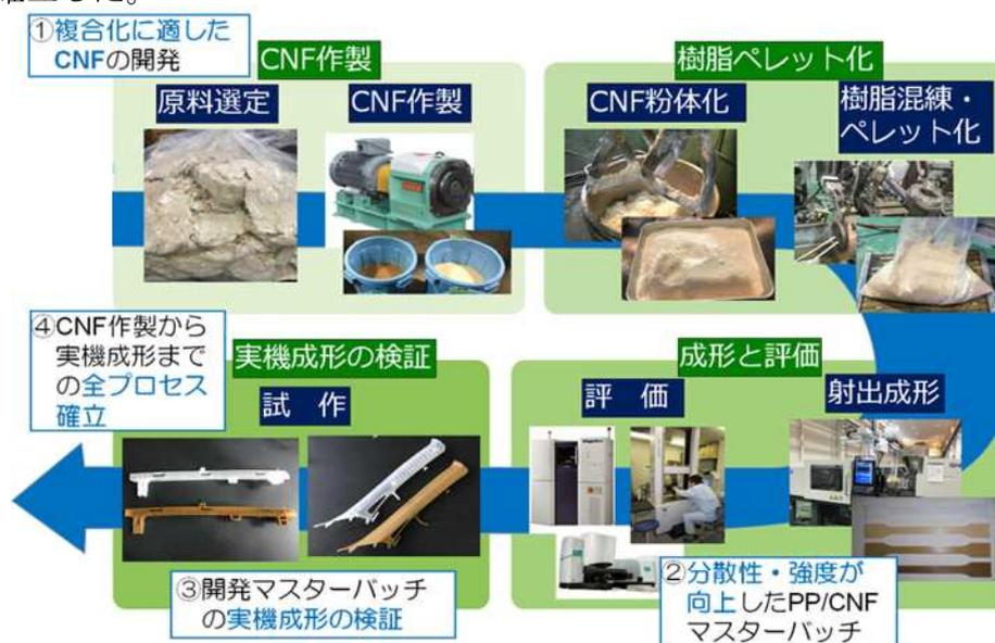
図 本プロジェクトで行った CNF の作製から実機成形までの開発の流れ
