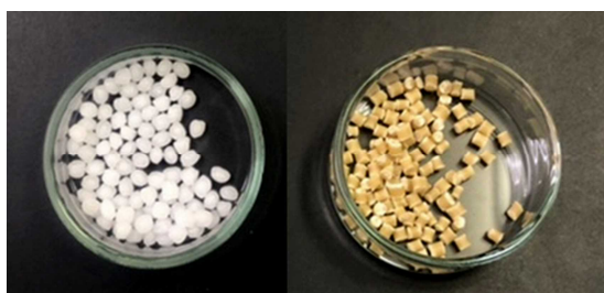
図1 PP/CNF 複合材料のペレット (左: CNF 濃度 0%、右: CNF 濃度 20%)
