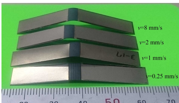
図1 走査条件による試験片外観の変化 (純チタン板厚0.2 mmの場合)
