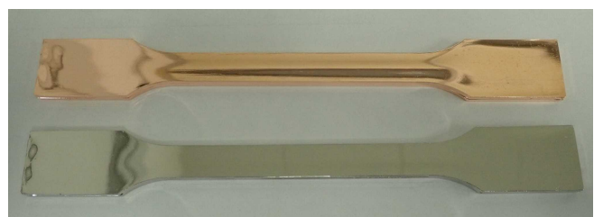
図 2 めっき試作品 (上:Cu めっき、下:Ni めっき)
