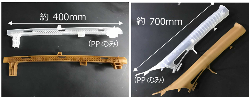
図 2 開発したマスターバッチを実機成形して試作した自動車部材（PP/CNF10%） （左：窓枠部材、右：ピラー）
