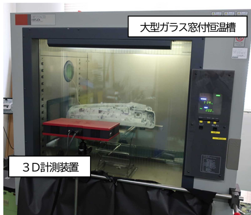
写真 熱変形評価試験の様子 恒温槽内の樹脂部品の変形を計測する
