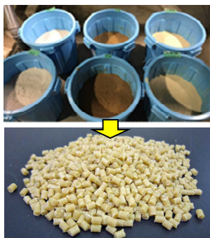
図 1 リファイナーで作製した CNF (上) と PP/CNF30% マスターバッチ (下)
