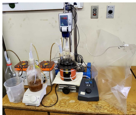
写真 従来装置(左)と新たに構築したメタン発酵試験装置(右)
