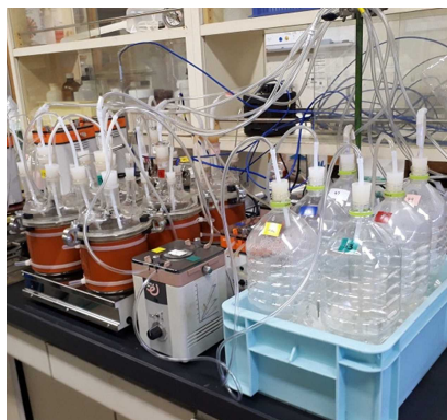
写真 従来装置(左)と新たに構築したメタン発酵試験装置(右)
