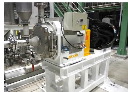
図2 新型リファイナー（相川鉄工(株)CNFテスト設備内）
