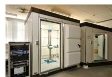
(写真)音響透過損失・残響室法
