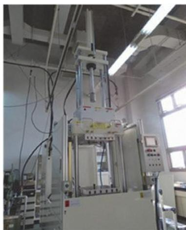
▲CFRP用トランスファ成形機（左）とその模式図（右）
