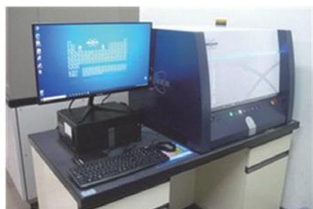
めっき等各種金属薄膜の厚さをX線により非破壊で迅速・簡便に測定します。多層膜の各層の厚さ、合金皮膜の厚さと組成、高速元素マッピング機能による広範囲の膜厚分布を測定する機能があります。R3年度オートレース補助事業により導入しました。
