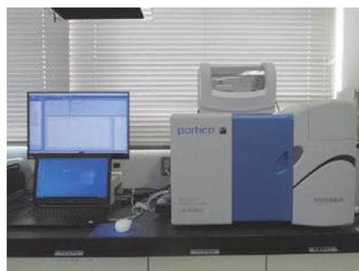
本装置は、分散状態の粒子にレーザー光を照射し、粒子の前後・上下・左右の回折・散乱光のパターンから粒子径と粒度分布を測定します。装置内部に取り付けられたカメラによって画像解析処理を行うこともできます。令和3年度本装置を導入しました。
