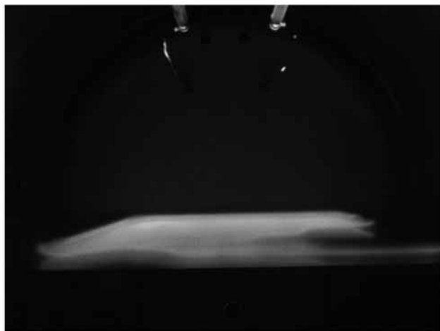
写真2 実証用プラズマ照射装置での窒素プラズマ発生状態 圧力10Pa 高周波出力30W 印加電圧400V
