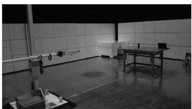
写真2 電波暗室における疑似実環境評価の様子
