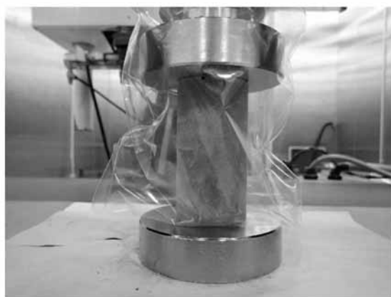
写真1 圧縮強度試験中の供試体
