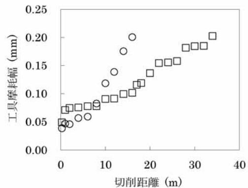
図2 切削距離の伸長に伴う工具摩耗の変化
