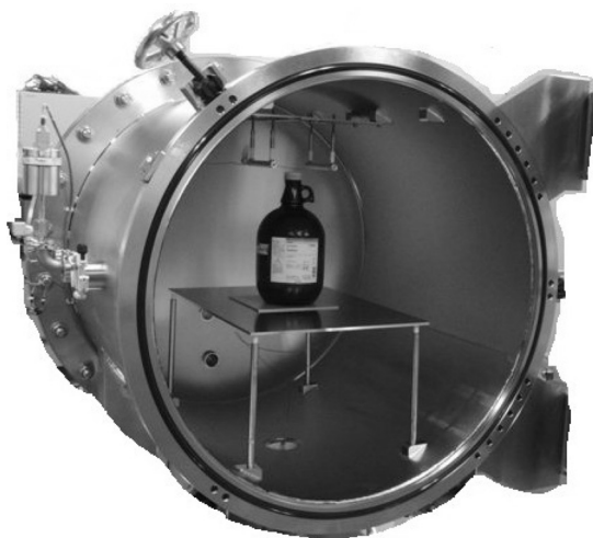
写真2 実証用プラズマ照射装置内部 ステージ（バイアス電極）のサイズは幅420mm、奥行600mm。写真のガロン瓶は比較のために置いたもの。
