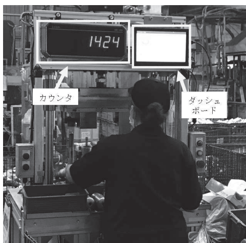
写真 ダッシュボード設置の様子
