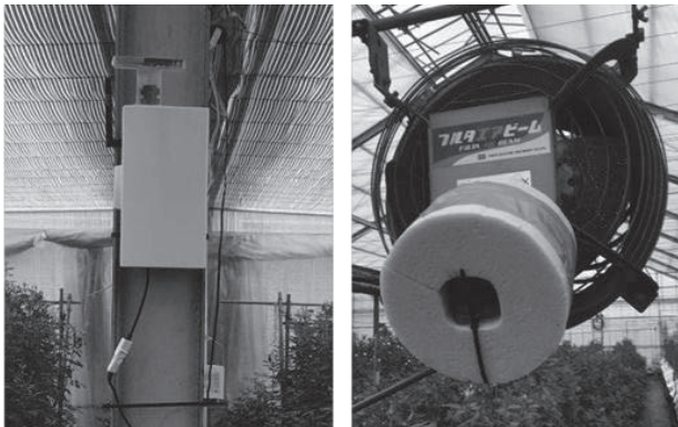
写真2 サーバ（左）とセンサノード（右）
