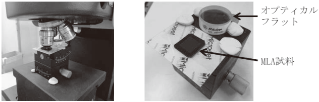
写真3 分割測定 (左：測定の様子 右：試料設置の外観)
