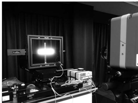
写真4 ニアフィールド配光測定装置
