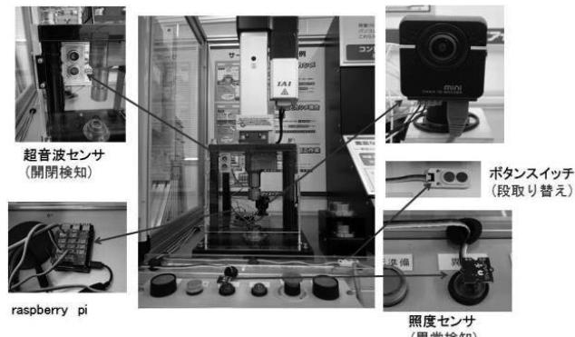
写真1 プレス機の見える化システム
