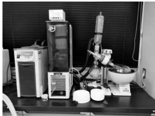
写真7 小型ロータリーエバポレータによる枝葉芳香蒸留水の試作
