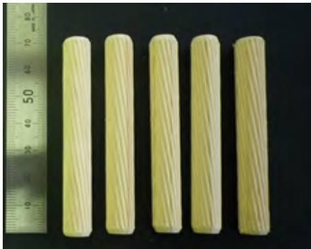
図1 試作したダボ(ヒノキ心材)
