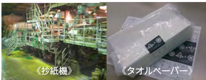
図1 工場実機抄紙機で試作したCNF添加機能紙 (タオルペーパー)
